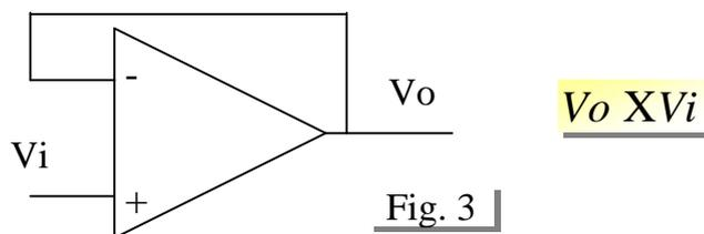
La configurazione inseguitore di tensione viene utilizzata come adattatore di impedenza. Infatti l'inseguitore ha:
