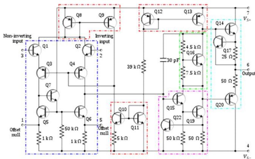
Internamente esso è formato da una rete di resistori, capacità, diodi e transistor e tali componenti sono tutti realizzati su un unico *chip di silicio* incapsulato in un contenitore di plastica.
